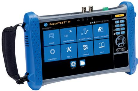
Tester Telecamera CCTV per Sistemi Analogici/Coassiale HD/Digitali IP
