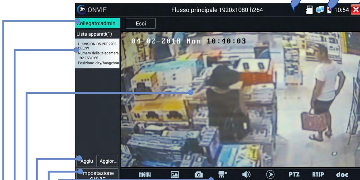
Toccare un'icona per visualizzare il menu di configurazione della telecamera, acquisire e riprodurre foto e video, controllare il brandeggio, intervenire sull'indirizzo RTSP (vedere la sezione PTZ), visualizzare anteprime e creare dei rapporti dei test (vedere la sezione Report test). Toccare e trascinare la barra degli strumenti per visualizzare l'icona "?".
