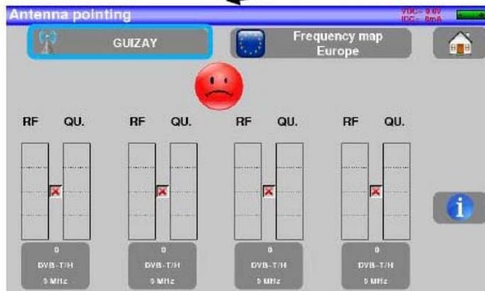
Inserite le 4 frequenze dell'emittente che intendete controllare.
