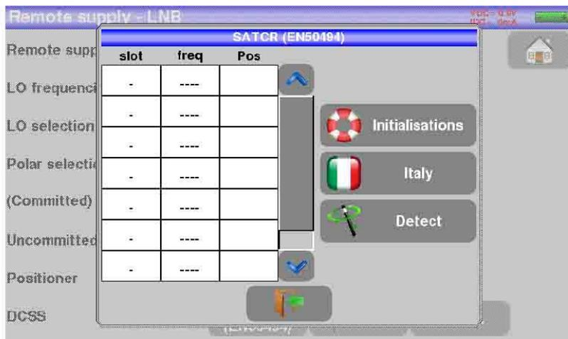
Lista degli slot, frequenze e commutatore Pos A/Pos B
